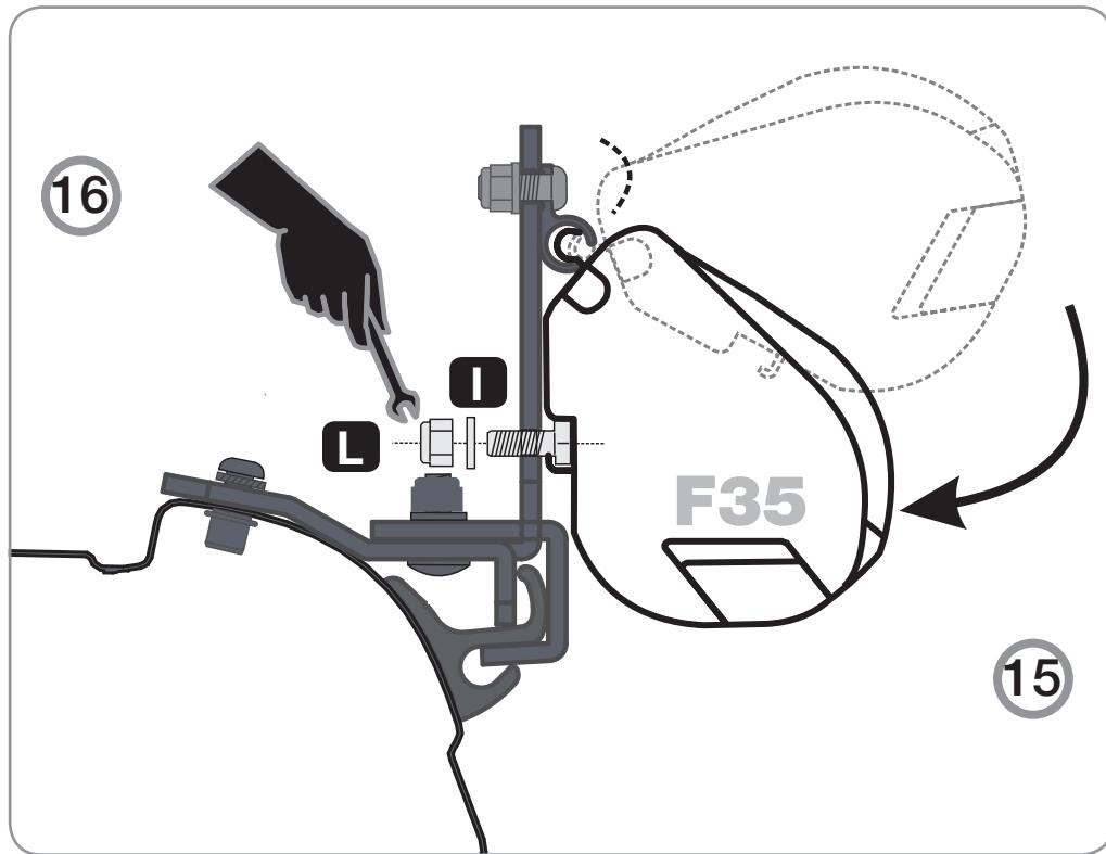
**DE** **ACHTUNG** Regelmäßig die Befestigung der Halterungen kontrollieren. Achten Sie vor allem nach dem ersten Sicherstellen darauf, dass sich die Haltebügel nicht verschoben haben.
